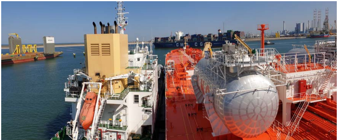
[그림 4] 삼성중공업 건조 LNG 연료추진 원유운반선(우측) LNG 추진중
