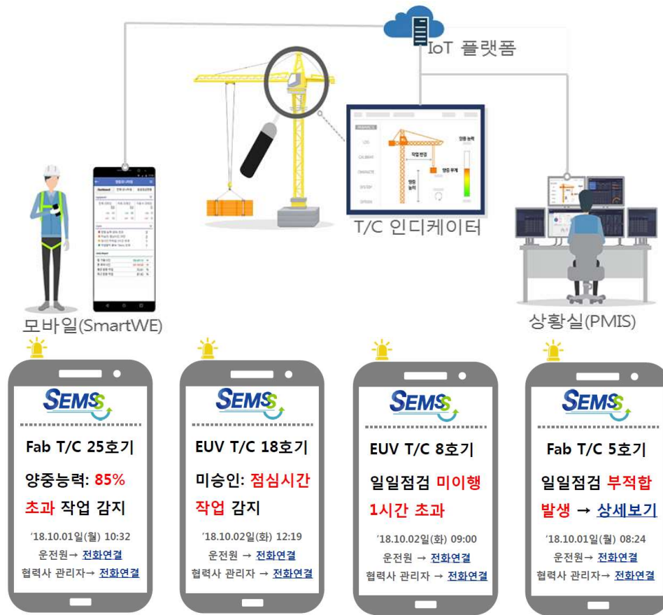
[그림 1] 장비안전관리시스템(SEMSS) 구성 및 기능
